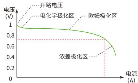
FCS3000软件基于实测的燃料电池极化曲线，支持用户通过.csv文件导入方式，下载到设备并实现燃料电池输出极化特性曲线的模拟。实验中，FCS3000燃料电池模拟软件将控制系统按照极化曲线改变输出电压，并实时记录电压，电流及功率等参数，为工程师研究燃料电池推进系统提供关键的实验数据。
