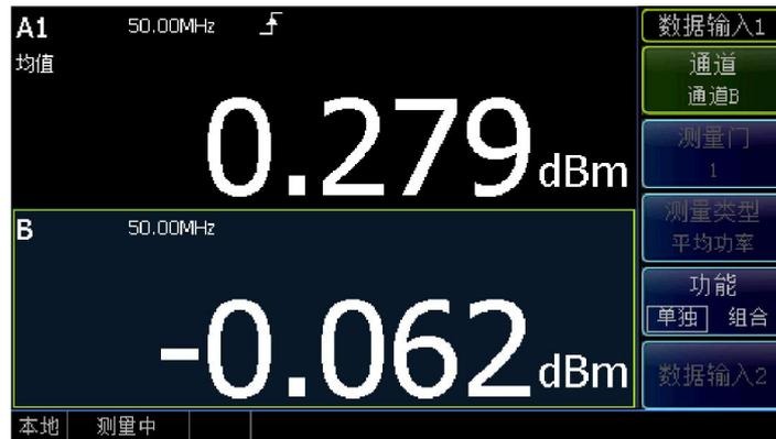
配接峰值功率探头时，即为高性能的峰值功率计。能够对 50MHz~67GHz 频段的脉冲调制信号进行功率和时间参数的测量分析。
